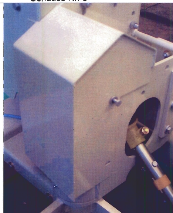
Bild 7: Abdeckung aus lackiertem Stahlblech
